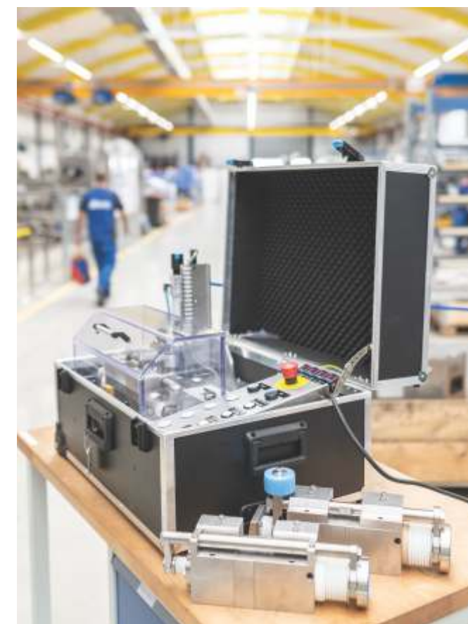
A estação móvel de revisão e teste da KHS facilita uma manutenção contínua muito mais rápida das válvulas de enchimento no local
