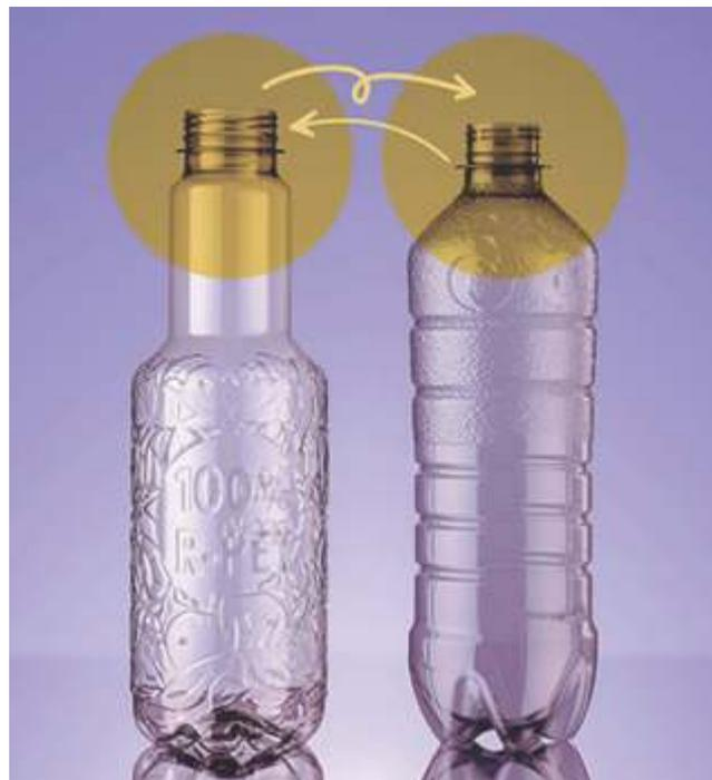
InnoPET Blomax 16 com capacidade de até 48.000 garrafas por hora, cerca de 170 suportes de mandril e proteções devem ser trocados manualmente. Por isso, esta parte da troca do gargalo é particularmente relevante no cálculo do tempo total necessário – ao contrário da troca de apenas 20 garras, que pode ser feita com relativa rapidez.
