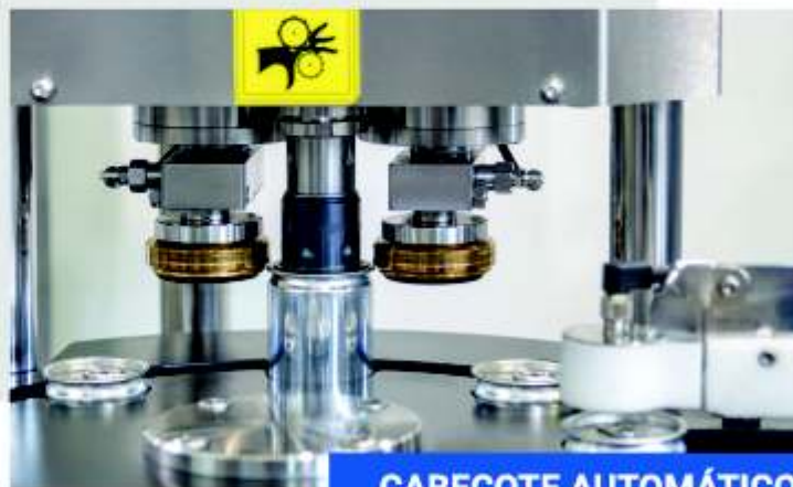
CABEÇOTE AUTOMÁTICO COM LUBRIFICAÇÃO CENTRALIZADA E A CIONAMENTO POR CAMES
